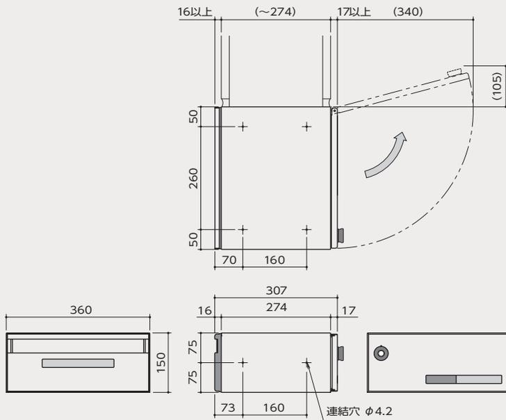
※外部設置する場合は、投入口側の水抜き穴を塞がないでください。
